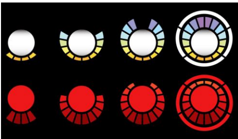
Fig. 3. Lichten voor en achter. De buitenste ringen werken als het remlicht van een auto.
